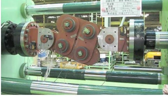
Şekil 2.13: Sürtünmeye dayalı sönümleyici (Damptech).
